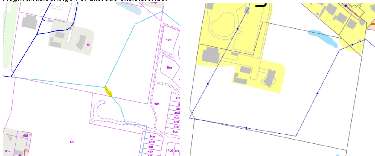
Figur 2. Billedet til venstre: Det rørlagte vandløb markeret gult på matr. 6i, resten af den lyseblå ledning på matriklen er BlueKoldings regnvandsledning. Billedet til højre: Udsnit af kort 15 (Lunderskov) i spildevandsplanen 2012-2019, de blå ledninger på kortet er regnvandsledninger tilhørende BlueKolding.
