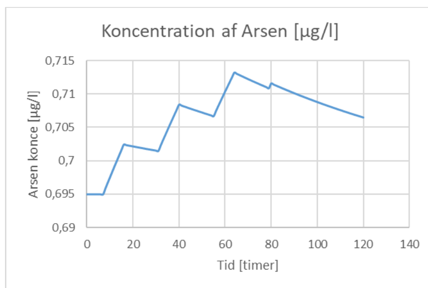
Figur 4-3 Tidslig udvikling i frigivelsen af arsen til vandfasen i Marina Syd. Frigivelse er lagt oveni den i forvejen forekommende koncentration i vandet på 0,695 µg/l.
