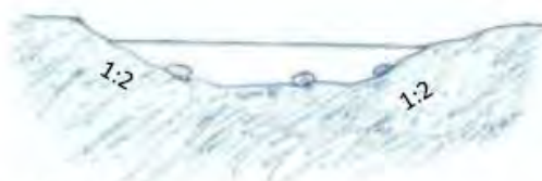
Figur 1: Principskitse for vandløbsprofilet for lige strækninger af det nye forløb. Anlægget kan variere i forhold til det angivne på kortet.
