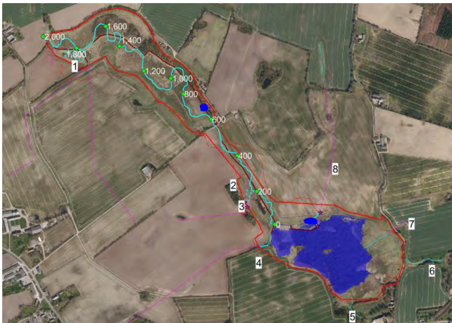
Kortbilag 7. Projektområde med markering af dræntilløb 1-8. Dræn (lyserøde streger) åbnes og ledes til sø/mose via overrisling (turkis streger mellem dræn og beskyttet natur). Bemærk at sø cirka ved st. 600 udgår.
