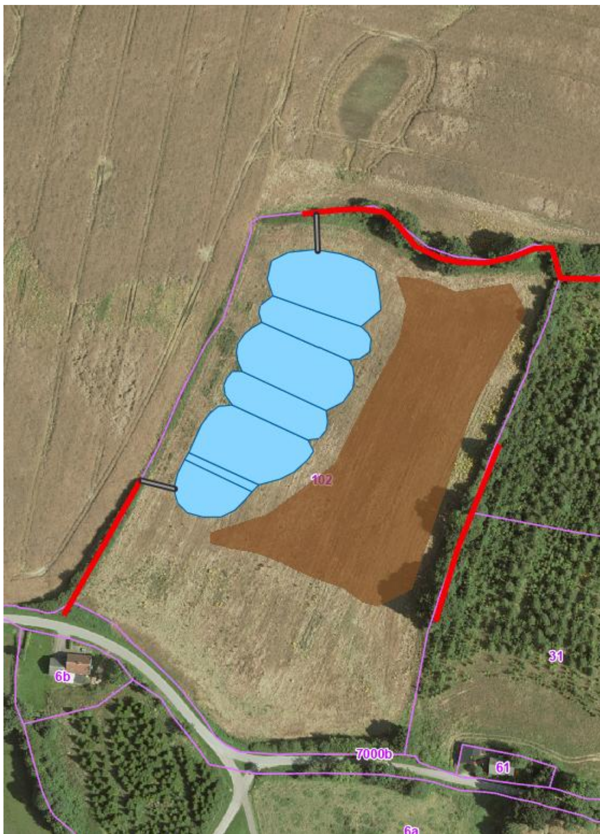
Kortbilag 2: Oversigtskort, der viser minivådområdets placering på matr.nr. 102 Bojskov, Tyrstrup. Overskudsjorden fra anlægsarbejdet spredes ud indenfor det brune polygon. Før udlægning afgraves muldjorden delvist (ca. 15 cm). Jorden lægges herefter ud i max 0,5 m. højde. Der skal desuden holdes en afstand på 10 meter fra foden af de beskyttede sten- og jorddigerne i forbindelse med anlægsarbejdet, og digerne må ikke beskadiges under anlægsarbejdet.
