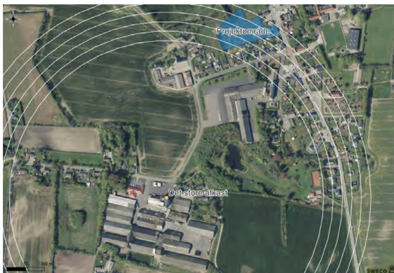
Figur 5.4: Receptornet anvendt i OML-beregningerne (hvide streger). Beregningscentrum svarende til det store afkast for Dansk Vilomix A/S er angivet med orange prik. Projektområdet er markeret med blå.
