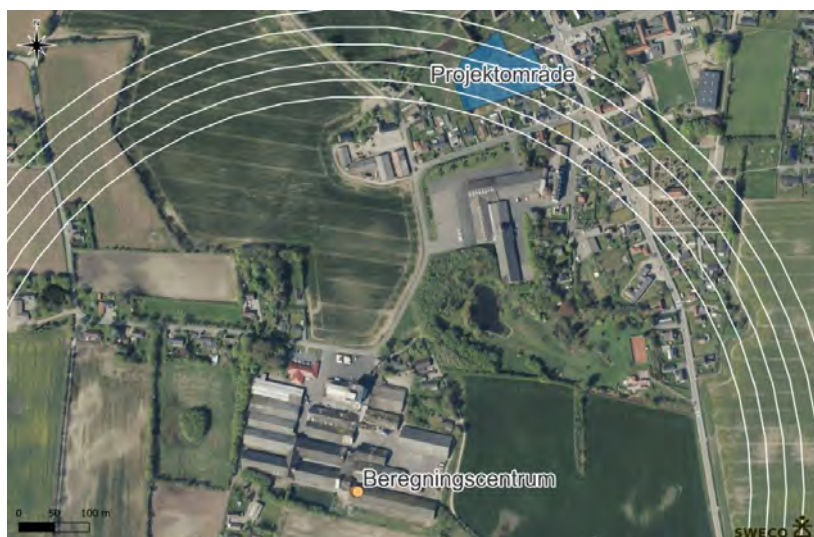
Figur 5.3: Receptornet anvendt i OML-beregningerne (hvide streger). Beregningscentrum svarende til det midterste afkast for Danish Agro er angivet med orange prik. Projektområdet er markeret med blåt.
