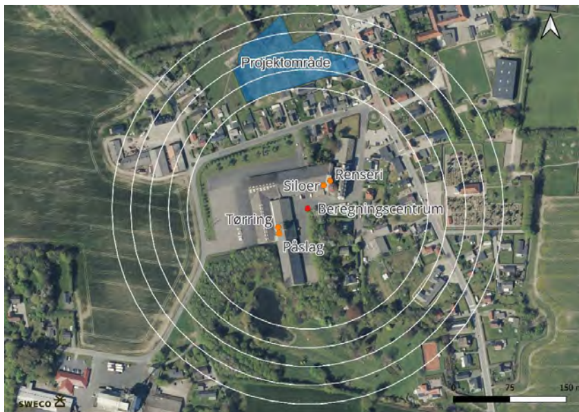
Figur 5.2: Receptornet anvendt i OML-beregningerne (hvide cirkler) til undersøgelse af virksomhedens støv-immission i projektområdet. Afkast er angivet med orange prikker og beregningscentrum er angivet med rød prik. Projektområdet er markeret med blå.
