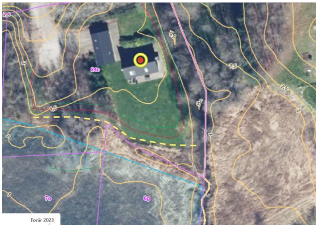
Figur 1. Oversigtskort med digets placering indtegnet, Grøn linje markerer digekanten og rød linje markerer digets krone. Mod nord sluttet diget til vejatrikel ført op til kote 2,5.
