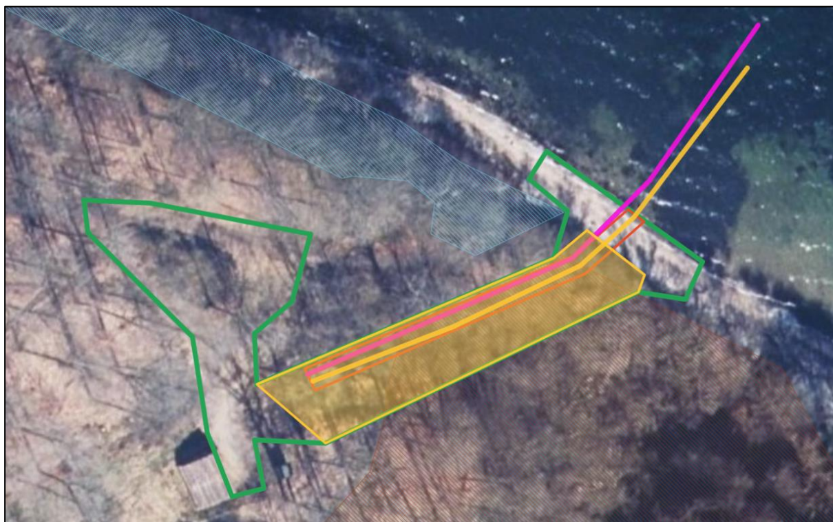
Figur 8-1 Oversigtskort med udpeget § 3 beskyttet natur i området for den nye udløbsledning. Med lyseblå skravering er vist strandeng og med brun skravering er vist mose. Med lyserød er vist den eksisterende udløbsledning, gul den supplerende udløbsledning, med rødt området for udgravning, med gult området for rydninger og med grønt det samlede arbejdsområde. Kilde: Arealinfo
