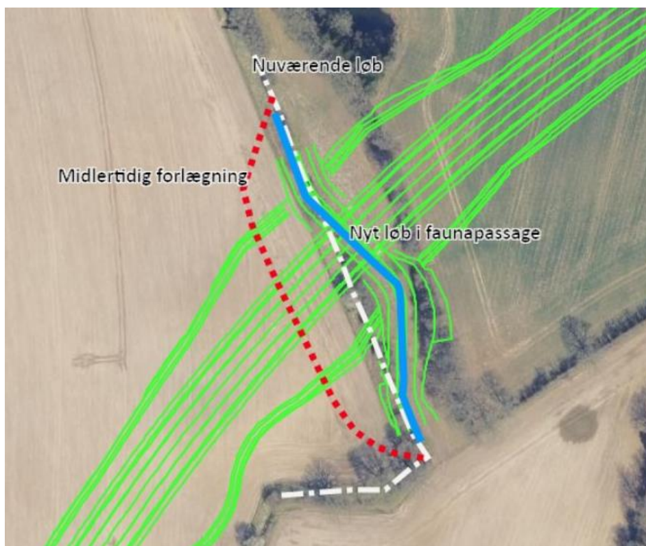
Figur 4: Midlertidig og permanent forlægning af Dalby Møllebæk. Den blå streg viser den permanente forlægning, hvor det nye forløb løber gennem en faunapassage. Den midlertidige forlægning (rød stippet streg) bliver i form af en rørlægning af vandløbet. Den hvide streg markerer Dalby Møllebæks nuværende forløb.
