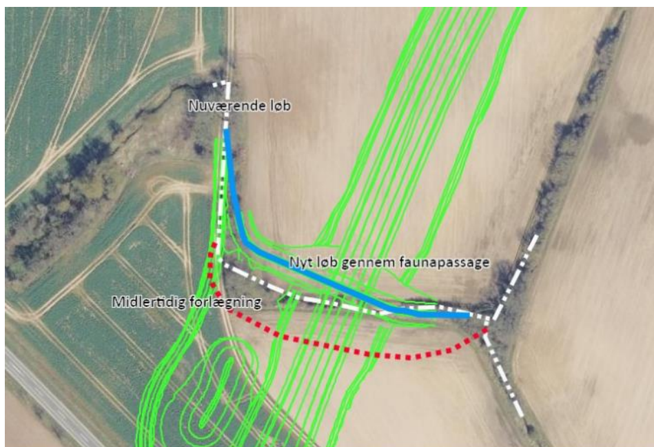
Figur 3: Midlertidig og permanent forlægning af Dalby Møllebæk. Den blå streg viser den permanente forlægning, hvor det nye forløb løber gennem en faunapassage. Den midlertidige forlægning (rød stippet streg) bliver i form af en rørlægning af vandløbet. Den hvide streg markerer Dalby Møllebæks nuværende forløb.
