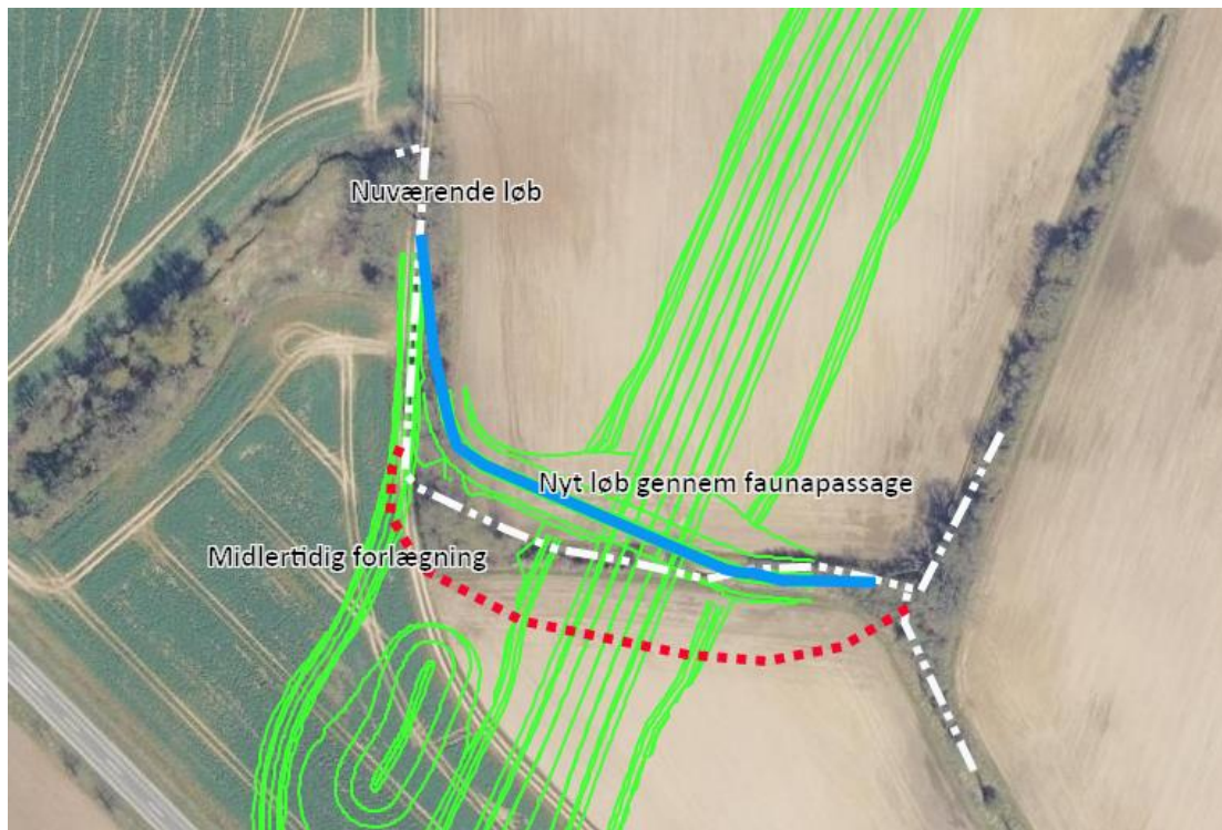
Figur 3: Midlertidig og permanent forlægning i St. 0+577
