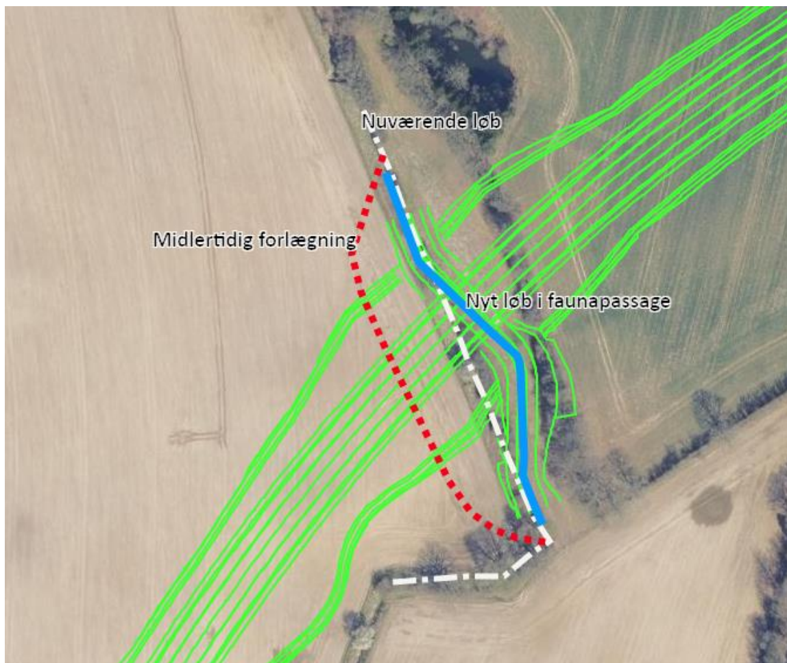
Figur 5: Midlertidig -og permanent forlægning i St. 0+945
